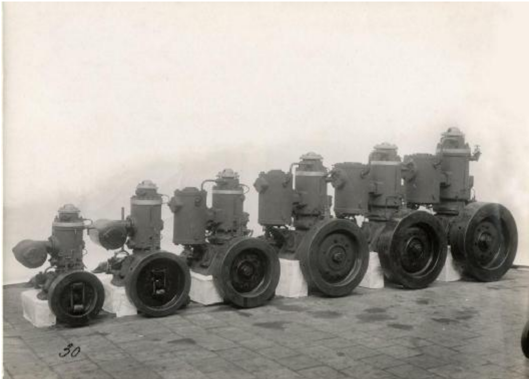
Afb. 5 Een serie ééncylinder scheepsmotoren van 8 tot 45 E.P.K. van Kromhout
